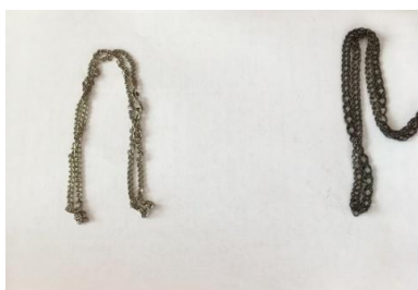
Иллюстрация 3 Результат воздействия сероводородной воды на серебряные цепочки
